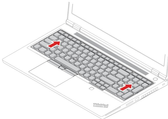
6. Schwenken Sie die Tastatur leicht nach oben **1** und drehen Sie dann die Tastatur um **2**.
