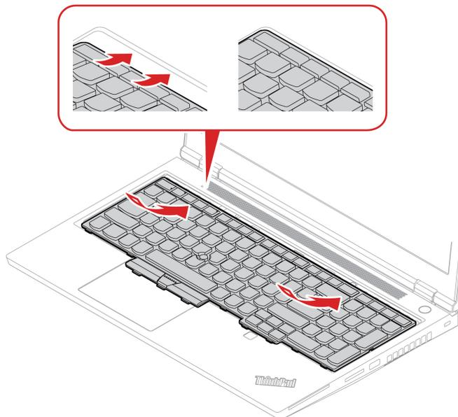
10. Schieben Sie die Tastatur in die dargestellte Richtung. Vergewissern Sie sich, dass die Verriegelungen unter dem Tastaturrahmen gesichert sind.
