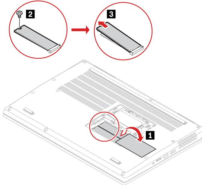
6. Installieren Sie ein neues M.2 Solid-State-Laufwerk:
