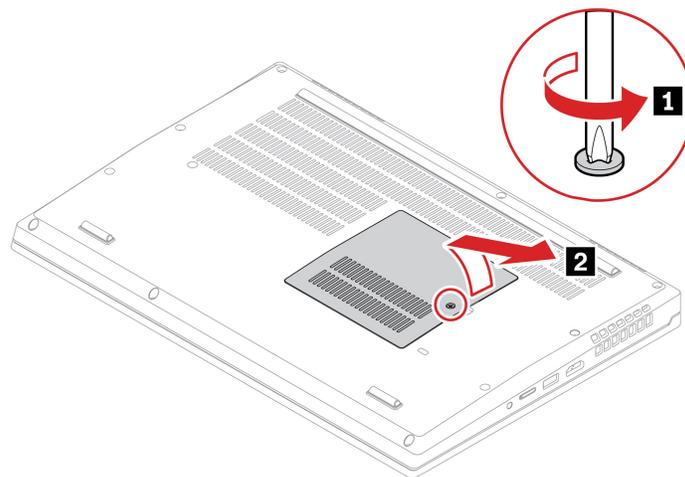
5. Installieren Sie die neue Klappe an der Unterseite an der entsprechenden Position **1**. Vergewissern Sie sich, dass die Verriegelungen unter der Klappe an der Unterseite gesichert sind. Bringen Sie die Schraube im Schraubloch in die korrekte Position. **2**.
