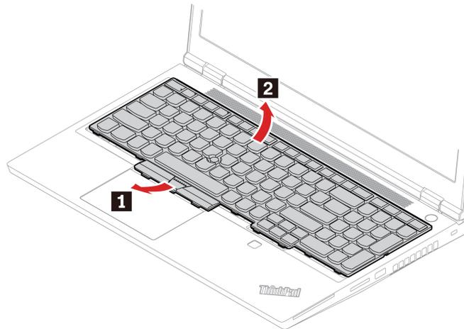
7. Legen Sie die Tastatur auf die Handablage, wie in der Abbildung dargestellt, und ziehen Sie die Steckverbinder ab. Entfernen Sie anschließend die Tastatur.
