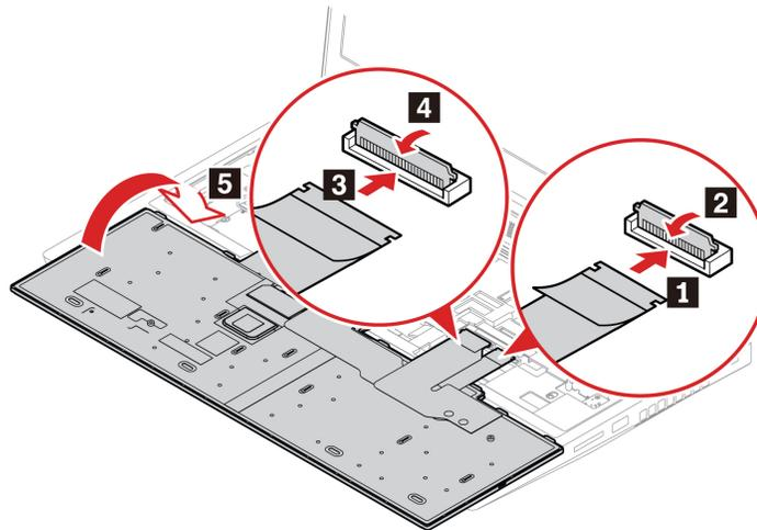
9. Setzen Sie die Tastatur wie abgebildet in die Tastaturblende ein. Vergewissern Sie sich, dass sich die obere Kante der Tastatur (die zum Bildschirm weisende Kante) unter der Tastaturblende befindet.
