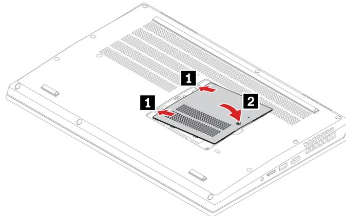
6. Ziehen Sie die Schraube fest, um die Klappe an der Unterseite zu befestigen.
